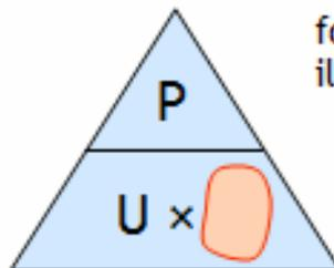
Pour calculer I en fonction de P et U, il suffit de **masquer** I.
