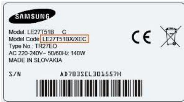
a) Calcule l'intensité du courant qui le traverse lorsqu'il est en fonctionnement.
